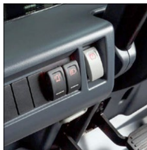
Freno di stazionamento azionato elettricamente, attivabile tramite pulsante.
